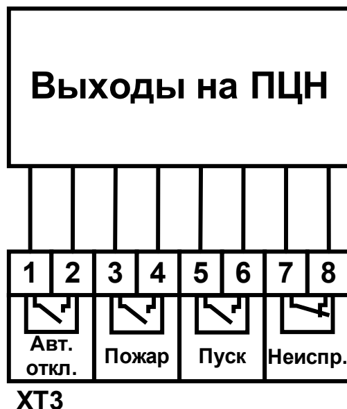
Рисунок 22 – Контакты для подключения выходов на ПЦН.
